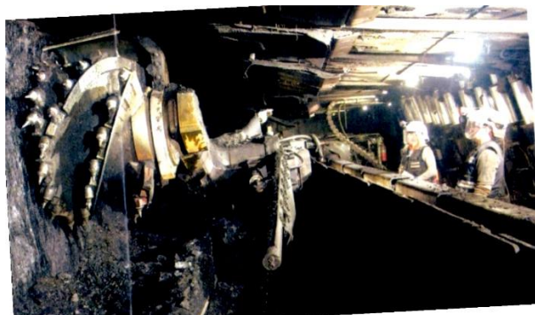
自走枠・ドラムカッター・チェーンコンベアを導入した採炭切羽
